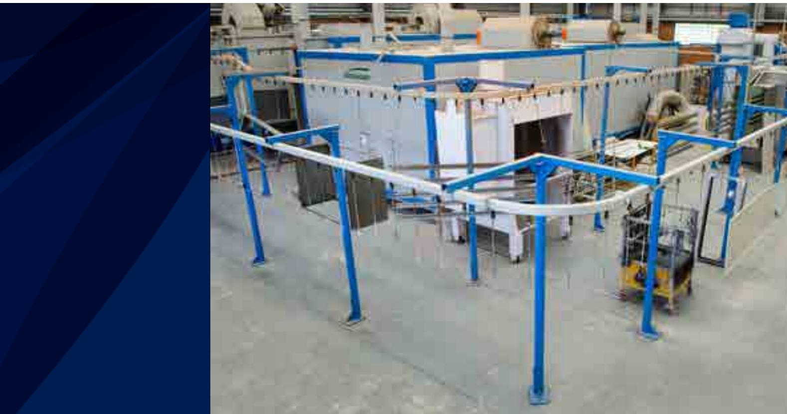
O preparo de superfície e pintura é realizado por processos de fosfatização estacionário e/ou linha de fosfato/pintura contínua e automática, pintura em cabines e cura em estufa estacionária, de acordo com as especificações de projeto e normas a serem aplicadas em cada projeto, tendo tecnologia desenvolvida para as mais diversas aplicações e atendimento a normas como Petrobras N 2841, Petrobras N 1735, ABNT NBR 15488, ABNT NBR 11388, ABNT NBR 14622, entre outras.
